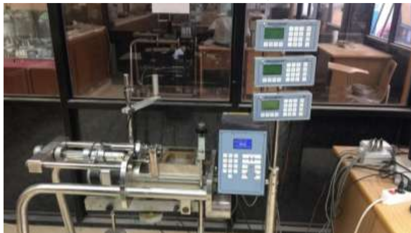
الشكل [3]: الجهاز(Tecnotest) المستخدم في قوى القص
